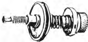
# TR2 tensione completa # 1430 asse # S-54 disco tensione # 4062 rondella di gomma # S2-631 (D-221) # 5098 molla # S2-684 disco di fermo # 3422 dado tensione # S2-602 # 6300
