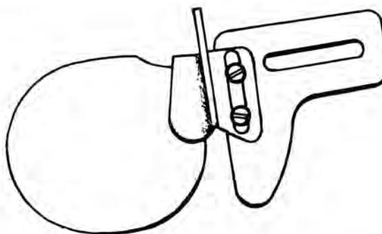
Orlatore inferiore montato su squadretta fissa si fornisce usando solo l'articolo
