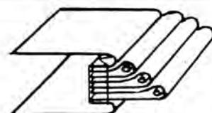
Guida per inserimento di un profilo prefabbricato per macchine tagliacuci a due aghi
