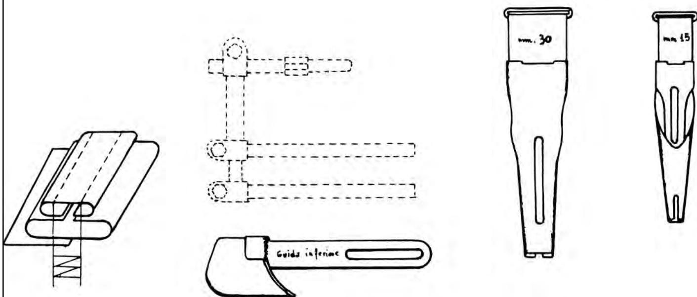
Guida universale per la formazione di una spallina elastica su macchina a 2 o 3 aghi
