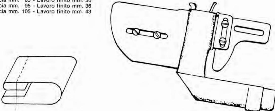
Profilatore doppio ad angolo per cinture JEANS su macchine RIMOLDI (Materiale medio e pesante)
