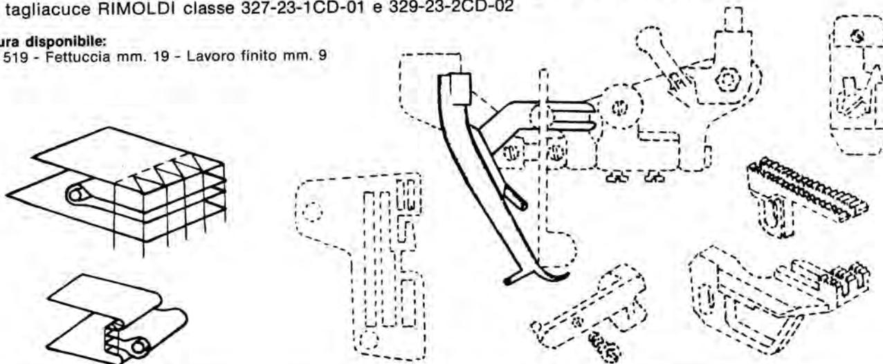
Guida per inserire profilo prefabbricato nel profilatore per tutti i tipi di collareto
