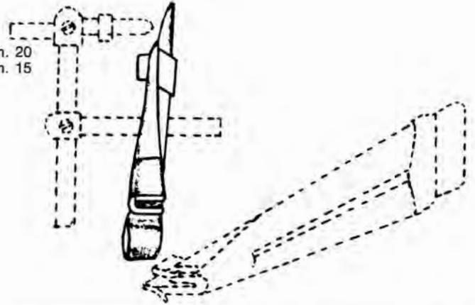
Profilatore semplice per Collaretto con inserimento profilo operazione unica
