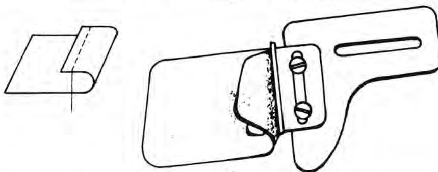
Orlatore superiore montato su squadretta fissa si fornisce usando solo l'articolo
