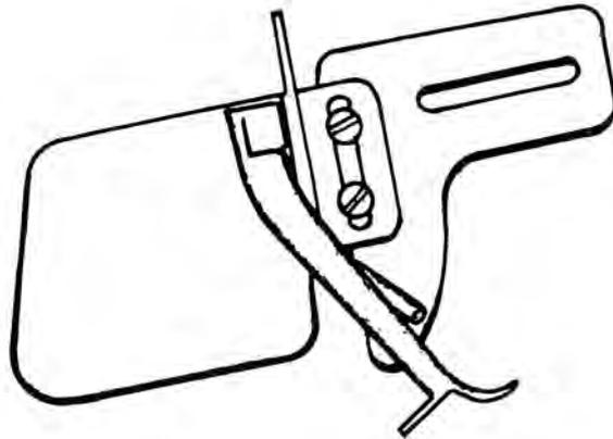
Guida per inserimento profili prefabbricati per macchine piane
